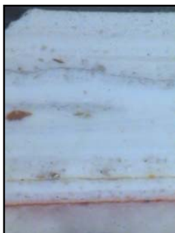
Nachweis über Fuchsinfärbetest am Querschliff
