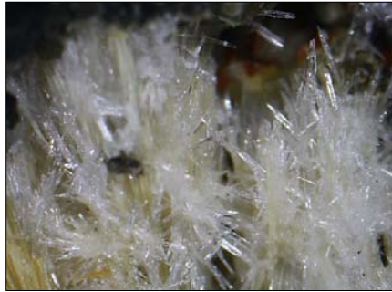
Thaumasyt [\text{Ca}_3\text{Si}(\text{OH})_6\cdot 12\text{H}_2\text{O}](\text{SO}_4)(\text{CO}_3)
